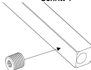
**Achtung:** Vierkantstift hat exzentrische Bohrung. Vierkantstift so einsetzen, dass die Spitze der Madenschraube an der dünnsten Stelle einbrechen kann
