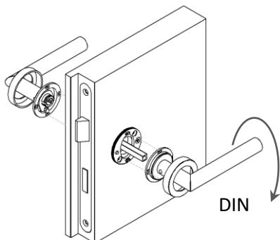
Posizionare la maniglia con la piastra di supporto sul perno e la serratura sulla base di montaggio. Rispettare la direzione DIN della maniglia affinché sia possibile spingerla verso il basso.
