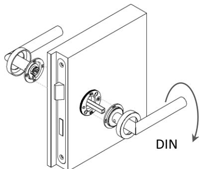
Placez la bêquille avec la rosace de maintien sur le carré en utilisant les ergots de fixation. Respectez le sens de la bêquille afin qu'elle puisse être poussée vers le bas (din droite ou gauche).
