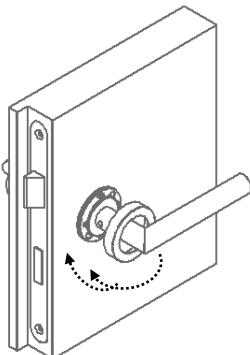
Ruotare saldamente l'anello
