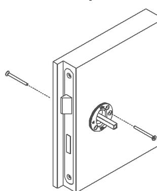
Veuillez fixer le socle de montage métallique sur la porte avec des vis M4 traversantes des deux côtés.
