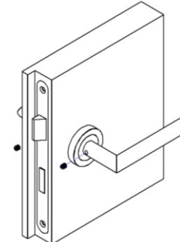
Innensechskantschrauben an beiden Türknaufen eindrehen und festziehen
