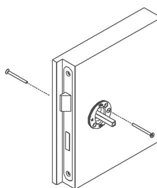
Avvitare la base di montaggio (in metallo) all'anta della porta con le viti M4.
